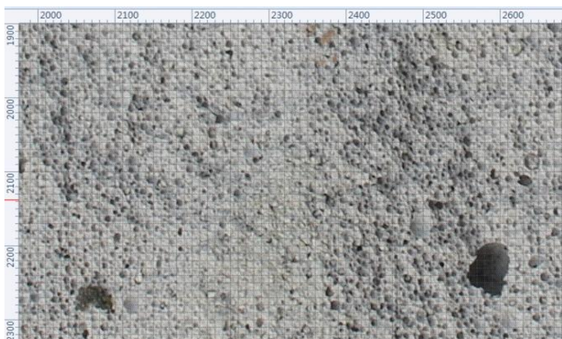
图C.2 表观气孔总体均匀、细密（偶现大气孔孔径 d_e < 5.0\text{mm} ）
