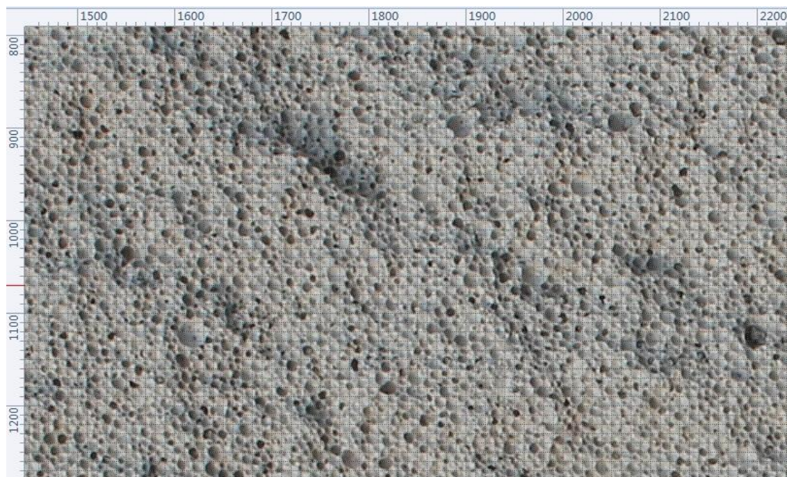
图C.1 外观气孔分布均匀、细密(最大等效孔径 d_e \leq 1.0\text{mm} )
