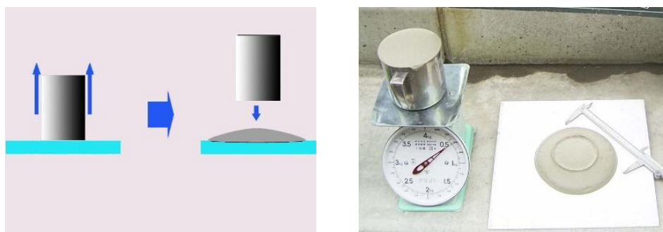
图B.1 湿容重、流动度测定示意图
